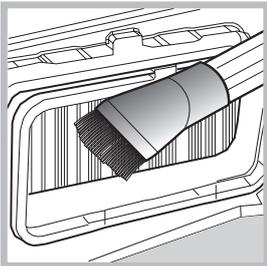
4. Gleichzeitig mit der Reinigung der Wärmepumpe muss auch der auf den Metallplatten angesammelte Schmutz mit einem feuchten Tuch, einem Schwamm oder einem Staubsauger beseitigt werden. Dazu
