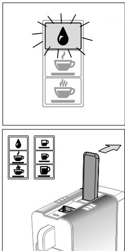
Energiespar-Betrieb ein: Reinigungstaste [●] wird langsam hell/dunkel (weiss)
