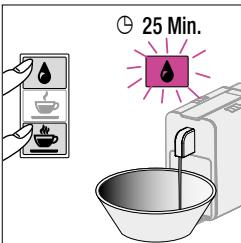
Tasten [ ] und [ ] gleichzeitig drücken: Taste [ ] blinkt violett und die Entkalkung startet. Der Entkalker wird in Intervallen durch die Maschine gepumpt. Der nächste Schritt folgt in 25 Min.
