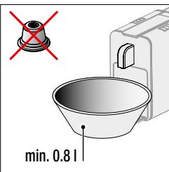
**Alle Kapseln** aus der Maschine **entfernen**. Hebel schliessen und **grosses Gefäss** (min. 0.8 l) unter Auslauf stellen. Falls [ ] langsam hell/dunkel leuchtet, beliebige Taste drücken
