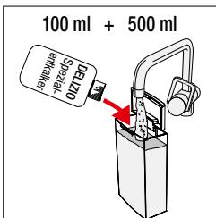
100 ml **DELIZIO-Spezialentkalker** mit 500 ml Wasser mischen und in Wassertank füllen.
