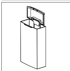
Wassertank mit lauwarmem Wasser und handelsüblichem Reinigungsmittel reinigen, ausspülen und trocknen lassen
