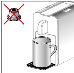
Tasse unter Auslauf stellen. Keine Kapsel einlegen. Falls die Reinigungstaste langsam hell/dunkel wird, beliebige Taste drücken
