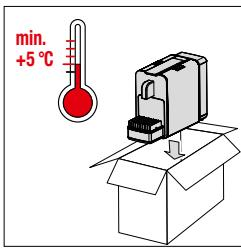
Um Aufbewahrungs-/Transportschäden zu vermeiden, Maschine vorher ausdampfen (= Wasser entfernen). Bei Temperaturen unter 5 °C zwingend notwendig
