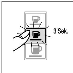
Die zu programmierende Taste, z.B.: , so lange **gedrückt halten** (min. 3 Sek.), bis sie 3x schnell und dann langsam blinkt. Anschließend langsames Blinken (= Aufheizen)
