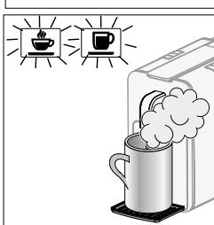
**Dampfaustritt** beim Auslauf: Verbrühungsgefahr! Sobald die Pumpe wieder verstummt, erlöschen die Tasten und der Vorgang ist abgeschlossen
