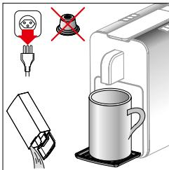
Netzstecker ziehen. Wassertank entleeren und wieder einsetzen. Tasse unter Auslauf stellen
