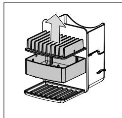
Kapselbehälter aus dem Restwasserbehälter nach oben abziehen. Gebrauchte Kapseln in Hausmüll entsorgen.
