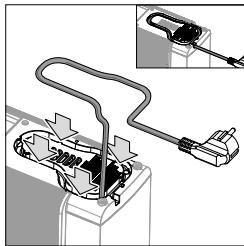
Ein zu langes Netzkabel kann auf der Unterseite in die Kabelhalterung gesteckt werden
