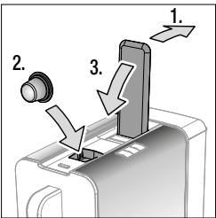
**Kapsel laden:** 1. Bedienhebel ganz nach hinten schwenken. 2. Kapsel gerade in Kapselschacht fallen lassen. 3. Bedienhebel ganz nach vorne schwenken (Kapsel wird aufgestochen).
