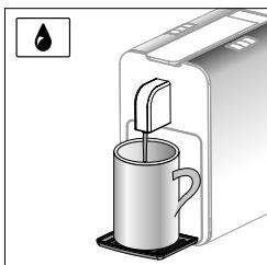
Reinigungstaste drücken, um den Spül-/Entlüftungsvorgang zu starten. Nach ca. 15 Sekunden stoppt die Pumpe und der Vorgang ist abgeschlossen
