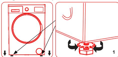
1. Non installare l'apparecchio su tappeti, moquette o altre superfici che possano bloccare la ventilazione alla base. La distanza tra l'apparecchio e il pavimento non deve essere ridotta con oggetti come tappeti, legno o nastri.
