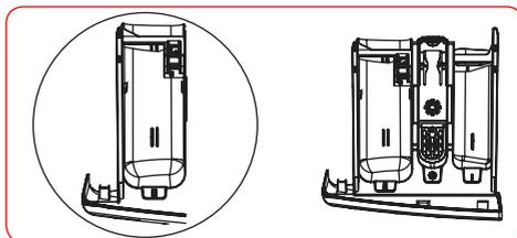
Questo scomparto è per detersivi liquidi o in polvere o detersivi anticalcare. La piastrina del livello del detersivo liquido è fornita all'interno dell'apparecchio. (\*)
