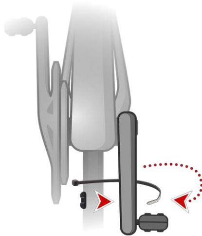
**Tipp:** Stellen Sie sicher, dass die einzelnen Teile des Kadenz- und Geschwindigkeitsmessers korrekt an Ihrem Fahrrad angebracht sind. Der Speichenmagnet sollte den größeren Teil des Kettenstrebensensors passieren und der Pedalmagnet die Spitze des Sensors.
