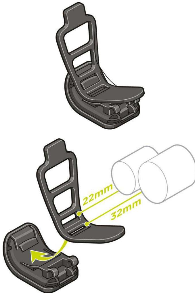
**Tip:** Der Riemen ist mit zwei Löchern ausgestattet, sodass er an Lenker verschiedener Größe passt (22 mm bis 32 mm). Verwenden Sie das Loch, bei dem der Riemen am besten am Lenker sitzt.
