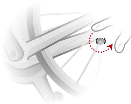
3. Passen Sie die Position des Speichenmagneten und Kettenstrebensensors so an, dass der Speichenmagnet die Spitze des größeren Teils des Kettenstrebensensors passiert, wenn sich das Rad dreht.
