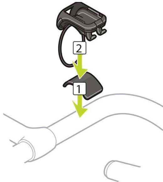
4. Legen Sie den O-Ring um die Lenkstange und schieben Sie ihn über die rückseitigen Haken.
