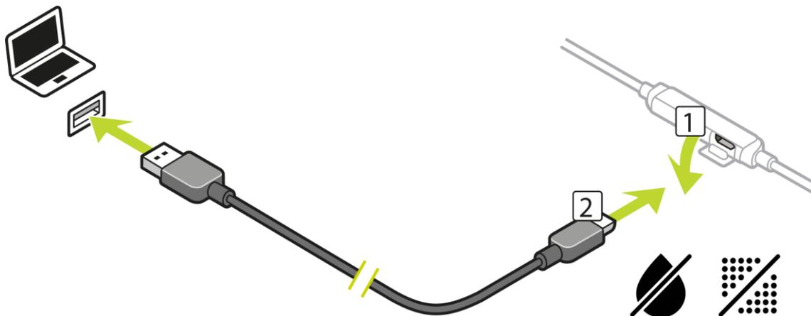
**Hinweis:** Wenn die Abdeckung der USB-Buchse offen ist, achten Sie darauf, dass kein Schmutz, Sand, Wasser usw. in die Buchse gelangt.
