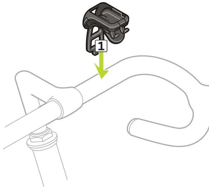
3. Befestigen Sie den Lenkerriemen mit dem Clip an der Unterseite der Gerätehalterung. Der Riemen sollte jetzt sicher am Lenker befestigt sein.
