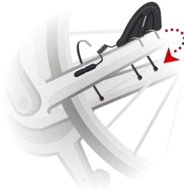
2. Bringen Sie den Speichenmagneten an einer der Speichen Ihres Fahrrads an. Der Magnet sollte in Richtung der Kettenstrebe zeigen, an der Sie den Kettenstrebensensor befestigt haben.
