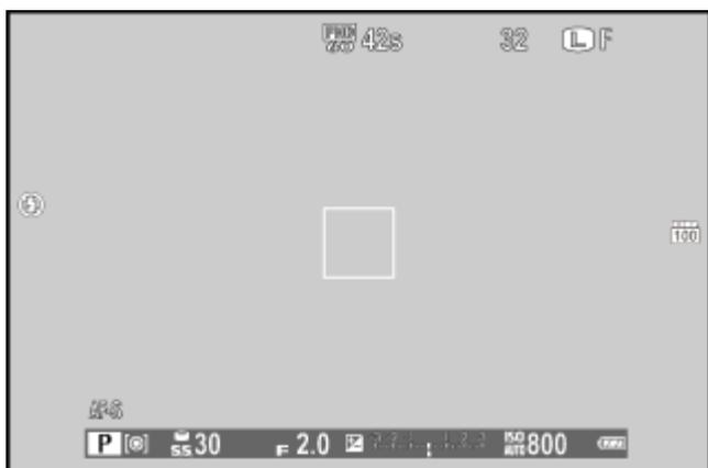
❗ Se il soggetto si trova al di fuori della gamma di misurazione della fotocamera, i display velocità otturatore e diaframma visualizzano “- - -”.
