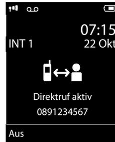
Beim Drücken einer beliebigen Taste wird die gespeicherte Nummer gewählt. Drücken Sie die Auflegen-Taste
