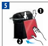
Befestigen sie das neue Seitenpanel wie auf dem Bild dargestellt. Stellen Sie sicher, dass das Panel ordnungsgemäß befestigt ist.
