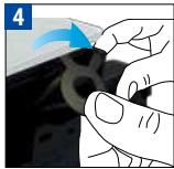
Entfernen Sie das Paneel, indem Sie den Nespresso-Key wie im Bild dargestellt drehen.
