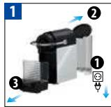
Ziehen Sie den Netzstecker und entfernen Sie den Wassertank und die Wartungseinheit.
