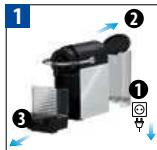
Débranchez la machine et retirez le réservoir d'eau et l'unité de maintenance.
