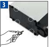
Utilisez la clé *Nespresso* dans les quatre orifices pour détacher les panneaux.
