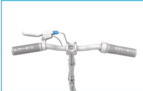
Bild: Einstellen der Stellschraube am Bremshebel
