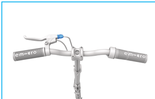
Image : Configuration de la vis de réglage sur le levier de frein
