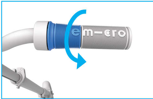
图片： 加速的旋转方向。
