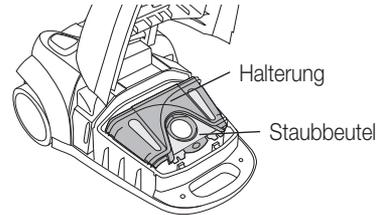
**Hinweis:** Darauf achten, dass die beiden unteren Teile des Staubbeutels nicht auf der Gummidichtung aufliegen, sondern nach unten ins Staubbeutel Fach hängen
