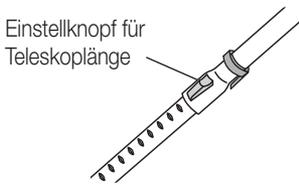
– Die Rohrlänge kann verändert werden: Wird der Knopf auf dem Teleskoprohr Richtung Düse geschoben, kann das Rohr auseinandergezogen (oder zusammengeschoben) werden.
