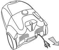
**Hinweis:** Nicht über den Endanschlag ziehen, um Beschädigungen des Kabels und der Aufrollvorrichtung zu vermeiden.
