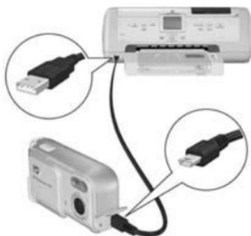
**b.** Connectez la grosse extrémité du câble USB livré avec votre appareil photo à la prise correspondante sur l'imprimante compatible PictBridge.
