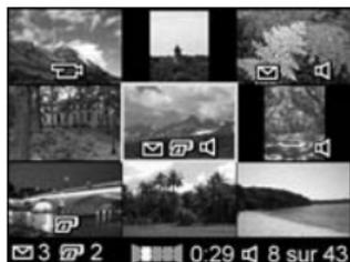
Au bas de l'écran, des icônes identifient les sélections de l'appareil photo pour l'image en cours (elles indiquent par exemple si l'image fait partie d'une séquence panoramique ou s'il s'agit d'un clip vidéo).
