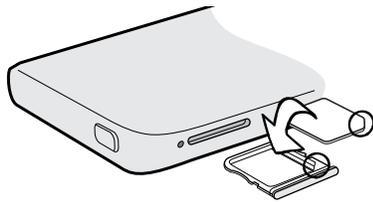
5. Inserire nuovamente il supporto della scheda SIM nel relativo slot.
