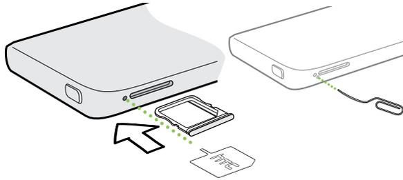
3. Premere completamente la punta nel foro fino a espellere il supporto della scheda SIM.
