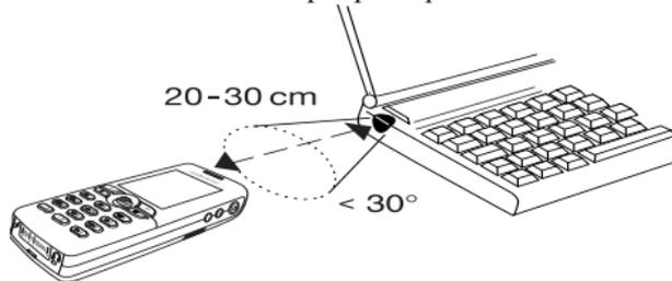
**Remarque :** Si vous établissez la connexion avec un PC, vérifiez si l'option de communication infrarouge de ce dernier est activée (Démarrer, Paramètres, Panneau de configuration, Infrarouge, onglet Options, Activer la communication infrarouge).
