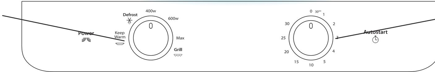
**2 DREHEN SIE DEN EINSTELLKNOFF** im Uhrzeigersinn, um die Garzeit einzustellen. Die Mikrowelle startet automatisch den Garvorgang.
