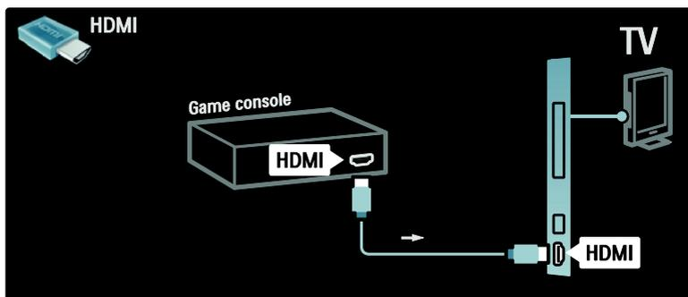
Si vous ne pouvez pas utiliser le connecteur latéral, utilisez un câble HDMI ou le câble EXT2 (YPbPr et Audio G/D) pour relier la console de jeux à l'arrière du téléviseur. (Sur certains modèles, EXT2 est nommé EXT3).
