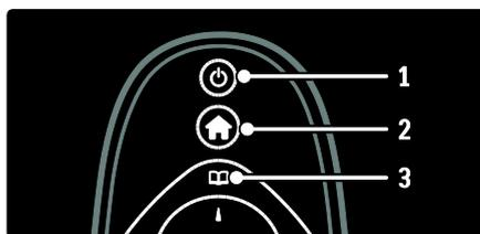
1. **⏻ (Marche/Arrêt)** : met le téléviseur en veille s'il est allumé. Allume le téléviseur s'il est en veille.
