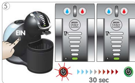
Maschine einschalten. Während die Maschine aufheizt, blinkt der Netzschalter rot. Nach ca. 30 Sekunden leuchtet der Netzschalter grün. Die Maschine ist bereit.
