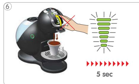
Nach Abschluss der Zubereitung blinken die Leuchtbalkenanzeige und der Netzschalter (rot) ca. 5 Sekunden. **Währenddessen darf der Arretierungsbügel nicht geöffnet werden!**
