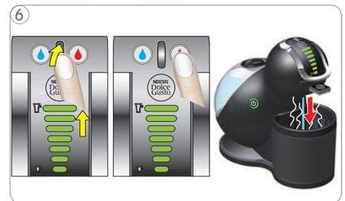
Maschine spülen: Leuchtbalkeanzeige mit dem Auswahrad auf Maximum stellen und Heißwassertaste drücken. Die Maschine beginnt zu spülen. Die Leuchtbalke erlöschen der Reihe nach.
