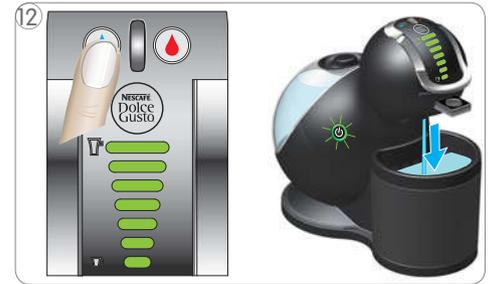
Kaltwassertaste drücken, um mit dem Spülen fortzufahren. Die Leuchtbalkenanzeige zeigt an, wie viel Zeit verbleibt. Am Ende des Spülvorgangs leuchtet der Netzschalter rot und die Leuchtbalkenanzeige zählt nach oben.
