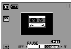
[ Tonaufnahme wurde vorübergehend angehalten ]
