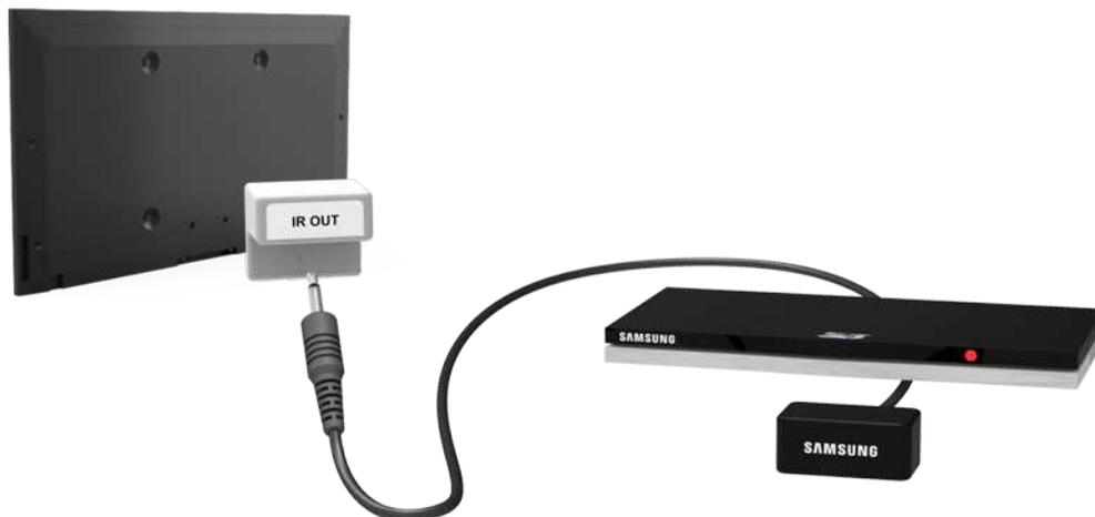
Verbinden Sie das eine Kabelende mit dem IR-Anschluss am Fernsehgerät, und richten Sie den Sender am anderen Ende des Kabels auf den Fernbedienungsempfänger des externen Geräts. Zwischen dem Sender am IR-Verlängerungskabel und dem Empfänger des externen Geräts dürfen sich jedoch keine Hindernisse befinden. Hindernisse stören die Übertragung des Fernbedienungssignals.
