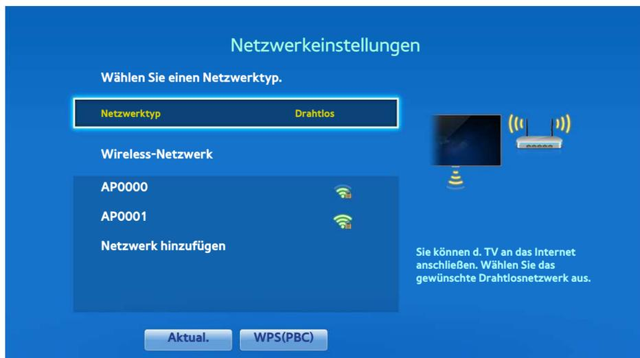
2. Wählen Sie das Netzwerk (SSID) aus, mit dem Sie die Verbindung herstellen möchten. Wenn der gewünschte WLAN-Router nicht in der Liste erscheint, wählen Sie **Netzwerk hinzufügen**, und geben Sie die SSID manuell ein.
