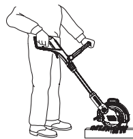
Arbeitsposition 3: Senkrecht Trimmen überhängender Rasenkanten
