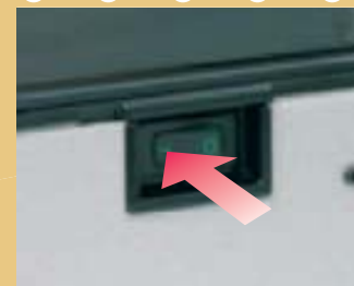
Premere l'interruttore sulla posizione "I" per accendere la macchina.
