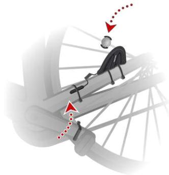
Wenn Sie die Sensoren in die richtige Position gebracht haben, ziehen Sie die Kabelbinder fest, sodass die Sensoren sicher fixiert sind.
