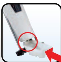
Die Auffangschale darunter stellen und die Ablassschraube herausdrehen
