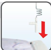
Kabelhalter in vorgesehene Öffnung einsetzen
