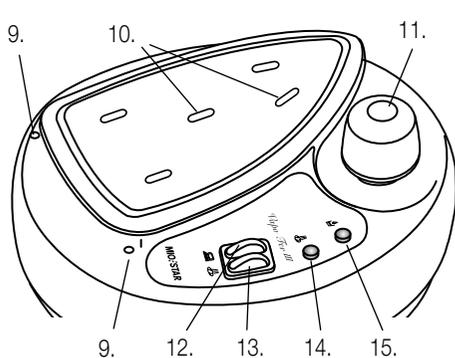
9. Orifice pour le support du tuyau
