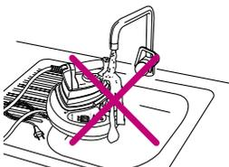
**Important:** La contenance maximum du réservoir du générateur est de 1.0 l. Sachez que le boiler du générateur contient toujours de l'eau résiduelle. Au remplissage, il se peut que des bulles d'air au niveau du goulot de remplissage se forment, empêchant l'eau de couler librement. Pour l'éviter, remuez légèrement le flacon pendant le remplissage. Ne pas placer le générateur sous l'eau pour le remplir: risque de court-circuit
