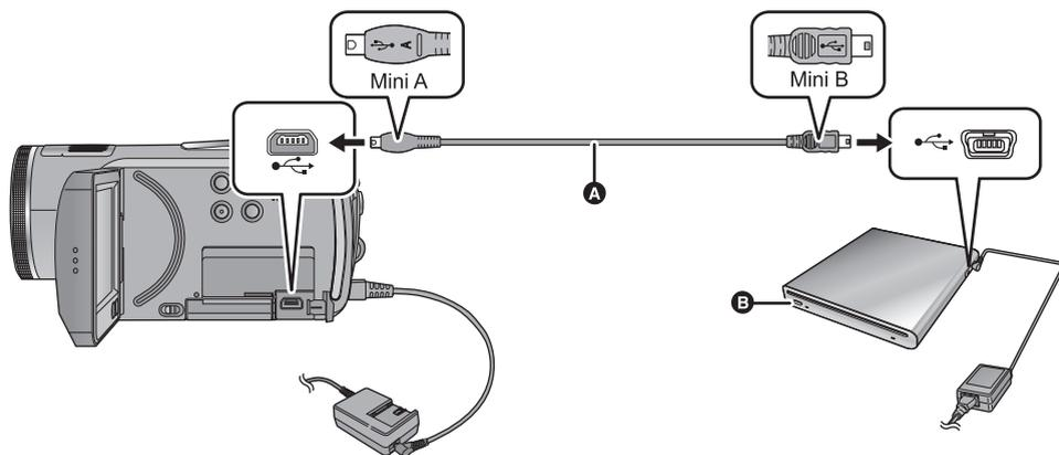
**A** Câble de connexion USB Mini AB (fourni avec VW-BN1)
