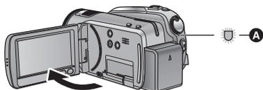
L'indicateur d'état **A** s'allume en rouge et l'appareil passe en pause d'enregistrement.
