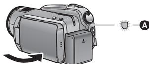
L'indicateur d'état **A** clignote en vert et l'appareil passe en mode veille au démarrage rapide.
