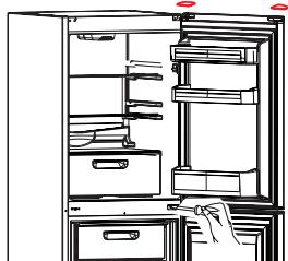
Der Türanschlag kann von rechts nach links gewechselt werden. Der Wechsel kann auch durch den MIGROS-Service durchgeführt werden. Für diese Arbeit ist eine zweite Person nötig.
