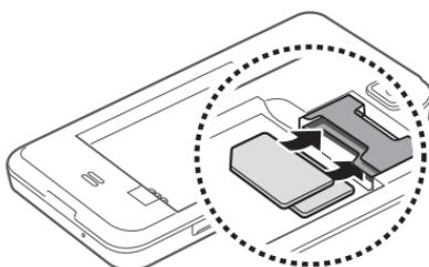
**!** Rimuovete prima la scheda SIM dallo slot superiore. Se rimuovete per prima la scheda SIM dallo slot inferiore, potreste danneggiare la scheda SIM.
