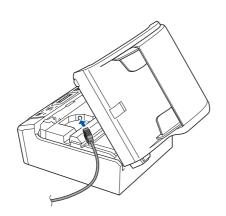
Guidez soigneusement le câble USB à travers la rainure comme indiqué ci-dessous, en suivant celle-ci autour et vers l'arrière de l'appareil. Connectez ensuite le câble à l'ordinateur.
