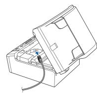
Guidez soigneusement le câble USB à travers la rainure comme indiqué ci-dessous, en suivant celle-ci autour et vers l'arrière de l'appareil.
