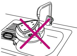
**Wichtig:** Der Dampferzeuger darf maximal 1.0 Liter Wasser enthalten. Bitte beachten Sie, dass sich im Boiler immer eine Restwassermenge befindet. Beim Einfüllen können Luftblasen in der Dampferzeuger-Öffnung ein weiteres Nachfüllen erschweren. Daher Flasche beim Einfüllen leicht bewegen. Station zum befüllen nie unter Wasserhahn halten: Kurzschlussgefahr!
