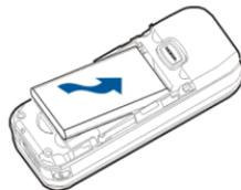
6. Allineare il cover posteriore alla parte posteriore del telefono cellulare e farlo scorrere verso l'alto. Spingere il cover posteriore fino alla parte superiore del telefono per bloccarlo.
