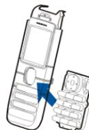
5. Allineare la parte superiore del cover anteriore alla parte superiore del telefono cellulare, premere il cover anteriore per farlo scattare in posizione.
