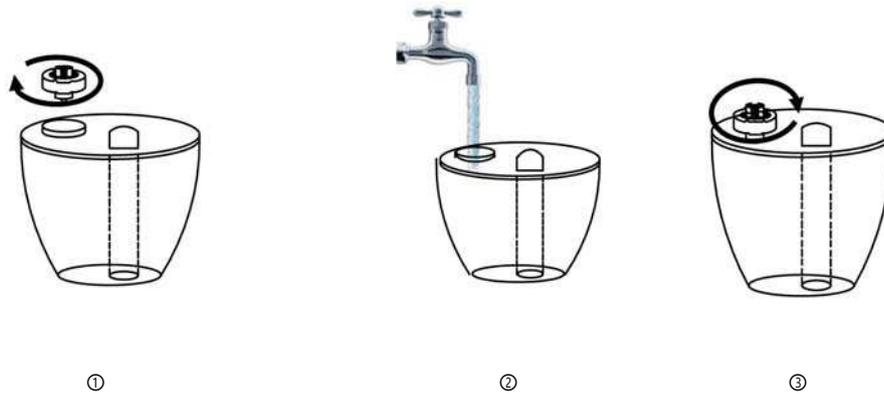
3. Schrauben Sie den Deckel wieder zu und bringen Sie den Wasserbehälter wieder so an, wie er zuvor eingesetzt war.
