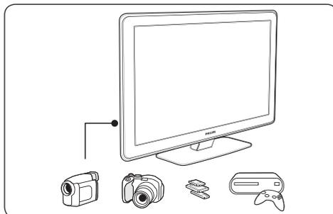
Utilizzare i connettori laterali del televisore per collegare dispositivi portatili quali videocamere o console di gioco ad alta definizione. È inoltre possibile collegare cuffie o dispositivi di memoria USB.
