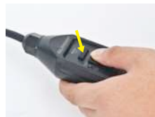
3. Drücken Sie die Test-Taste, die Anzeige erlischt.
