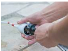
1. Verbinden Sie den Stecker mit der Steckdose.
