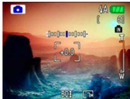
2. Usare il tasto **Sinistra/Destra** per regolare il valore d'esposizione dell'immagine. La portata va da EV -2,0 a EV+2,0 (con incrementi di 0,3).
