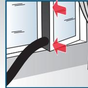
Fensterelement in Fensterspalt befestigen
