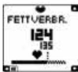
Wenn Sie sich in der gewünschten Zone befinden, drücken Sie für eine Sekunde die OK-Taste, um die Zone zu sperren. Es wird Fettverbr.-zone gesperrt oder Fitness-Zone gesperrt angezeigt. Der Armbandempfänger gibt ein akustisches Signal, wenn Ihre Trainingsintensität zu hoch oder zu niedrig ist. In dieser Abbildung ist beispielsweise die Fettverbrennungszone gesperrt. Um eine Zone zu entsperren, drücken Sie für eine Sekunde die OK-Taste.
