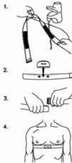
**i** Entfernen Sie die Sendeeinheit nach jeder Verwendung vom Gurt, um die Lebensdauer der Senderbatterie zu verlängern. Schweiß und Feuchtigkeit können bewirken, dass die Elektroden feucht bleiben und der Sender aktiviert bleibt. Dies verringert die Lebensdauer der Senderbatterie.
