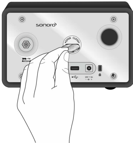
Fig. 8: Mise en place de la pile
