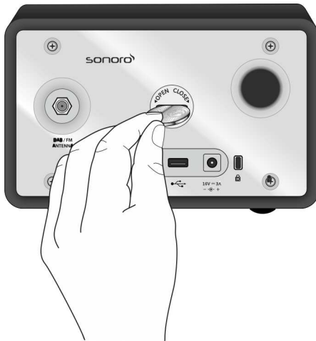
Fig. 8: Inserimento della batteria
