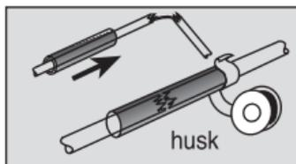
manchon sur le tube jusqu'à la cassure, et fixez-le au moyen d'une bande adhésive. Un segment endommagé peut être facilement remplacé. Pour cela, il vous suffit
