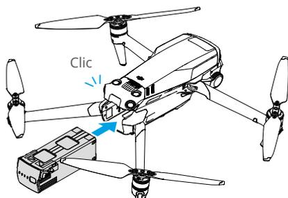
Appuyez et maintenez appuyée la partie texturée des glissières sur les côtés de la batterie pour la retirer du compartiment.
