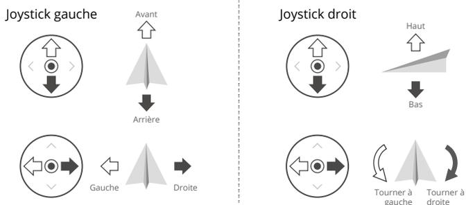
Le mode de contrôle par défaut de la radiocommande est le Mode 2. Dans ce guide, le Mode 2 est utilisé comme exemple pour illustrer l'utilisation des joysticks.
