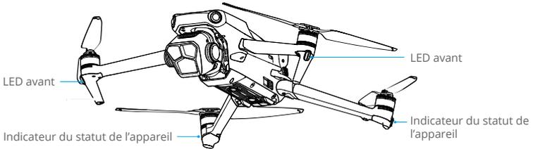
Lorsque l'appareil est sous tension mais que les moteurs ne tournent pas, les LED avant s'allument en rouge fixe pour indiquer l'orientation de l'appareil.
