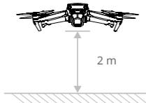
2. Dans l'application DJI Fly, appuyez sur l'icône du mode de prise de vue pour sélectionner MasterShots et suivez les instructions. Confirmez que vous comprenez comment utiliser le mode de prise de vue et qu'aucun obstacle n'est présent dans les environs.
