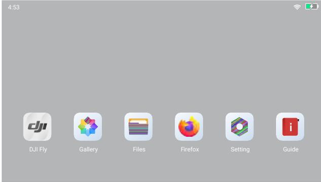
La partie supérieure de l'écran tactile affiche l'heure, le signal Wi-Fi et le niveau de batterie de la radiocommande.
