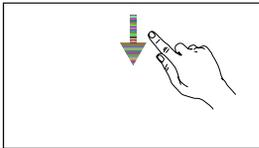
Faites glisser vers le bas depuis le haut de l'écran pour ouvrir la barre de statut lorsque vous êtes dans l'application DJI Fly. La barre de statut affiche l'heure, le signal Wi-Fi, le niveau de batterie de la radiocommande.
