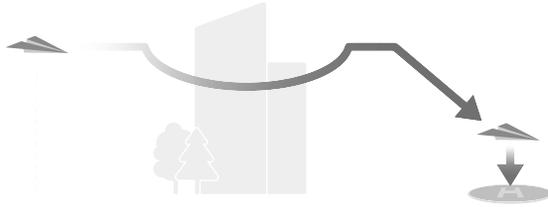
2. **Prédéfini** : lorsque l'appareil se trouve à plus de 50 m du point de départ au début du RTH, l'appareil planifie la trajectoire RTH, vole vers une zone ouverte tout en évitant les obstacles, monte à l'altitude RTH et retourne au point de départ en utilisant la meilleure trajectoire.
