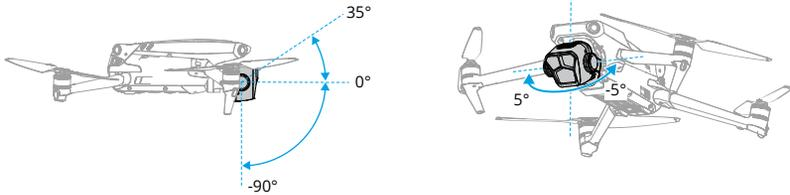
Utilisez la molette de nacelle sur la radiocommande pour contrôler l'inclinaison de la caméra. Sinon, vous pouvez accéder à la vue caméra dans l'application DJI Fly. Appuyez sur l'écran et maintenez jusqu'à ce que la barre de réglage de la caméra apparaisse. Faites glisser la barre vers le haut ou vers le bas pour contrôler l'inclinaison et vers la gauche ou la droite pour contrôler l'axe panoramique.
