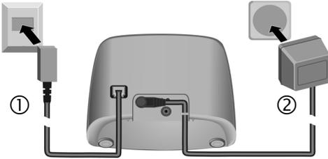
Collegare la spina telefonica con il relativo cavo ①, quindi inserire sia la spina dell'alimentatore ② (230 V) che quella della linea telefonica nelle prese a muro, come indicato in figura. Inserire poi i cavi nelle apposite scanalature. Entrambi i cavi devono essere **sempre inseriti** nelle rispettive prese.
