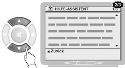
3 - Ist der Text sehr lang, ist er in Seiten unterteilt. Drücken Sie die Taste ▲, um die nachfolgende Seite bzw. die Taste ▼, um die vorangegangene Seite anzuzeigen.
