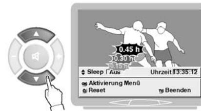
2 - Drücken Sie eine der Tasten  $\blacktriangle$  so oft, bis die gewünschte Zeit angezeigt wird. Maximal können 2h eingestellt werden.
