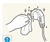
Wenn die Stifte des Netzsteckers oder der Steckdose staubig sind, müssen Sie sie mit einem trockenen Tuch reinigen.
