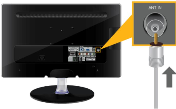
1. Schließen Sie das Kabel-/Satellitensystem oder das Kabel der Fernsehantenne an den [ANT IN]-Eingang auf der Rückseite des Monitors an.
