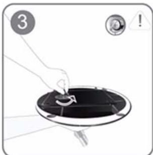
Drehen Sie die Befestigungsschraube unten am Standfuß, um sie zu lösen.
