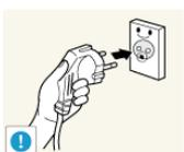
Schließen Sie das Netzkabel nur an eine geerdete Steckdose (für Geräte der Isolationsklasse 1) an.
