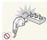
Schließen Sie keinesfalls mehrere Elektrogeräte an eine einzige Steckdose an.
