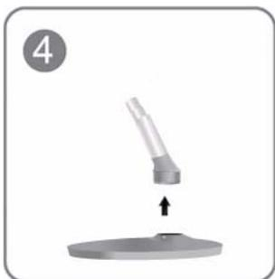
Nehmen Sie den Standfußanschluss aus dem Standfuß. Ziehen Sie ihn dazu in Pfeilrichtung (siehe Abbildung).
