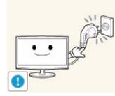
Schließen Sie den Netzstecker an eine leicht erreichbare Wandsteckdose an.
