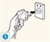
Fassen Sie das Netzkabel am Stecker und nicht am Kabel an, wenn Sie es aus der Wandsteckdose ziehen.
