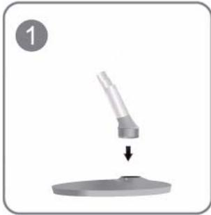
Setzen Sie den Standfußanschluss in der Richtung in den Standfuß, die in der Abbildung gezeigt ist.
