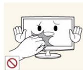
Wenn das Gerät längere Zeit angeschaltet ist, wird die Anzeige heiß. Fassen Sie das Gerät also nicht an.
