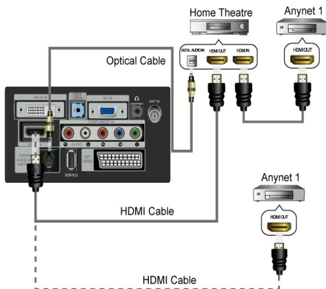
1. Verbinden Sie einen der Anschlüsse **[HDMI IN]** am Fernsehgerät mit dem HDMI OUT-Anschluss am entsprechenden <Anynet+>-Gerät. Verwenden Sie hierfür das HDMI -Kabel.
