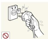
Berühren Sie den Netzstecker beim Einstecken und Trennen der Verbindung nicht mit feuchten Händen.
