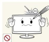
Führen Sie weder Metallgegenstände wie Besteck, Münzen oder Haarnadeln, noch leicht entflammare Gegenstände (durch Lüftungsschlitze, Anschlüsse) ins Innere des Geräts.
