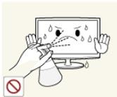
Sprühen Sie keine Reinigungsmittel direkt auf das Gerät.
