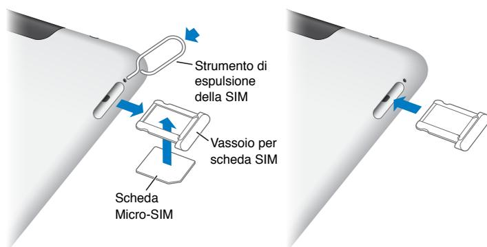
**Aprire il vassoio della scheda SIM:** Inserisci la punta dello strumento di espulsione della scheda SIM nel vassoio della scheda SIM. Premi con forza verso il basso lo strumento di espulsione finché non esce lo sportello. Estrai il vassoio della scheda SIM per installare o sostituire la scheda micro-SIM. Se non disponi della graffetta per la rimozione della SIM, puoi utilizzare una normale graffetta piccola.
