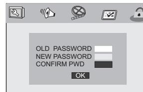
**OLD PASSWORD**: Geben Sie das alte Passwort ein (das werksmäßig eingestellte Passwort ist 1369). Die Eingabe wechselt danach automatisch auf NEW PASSWORD.
