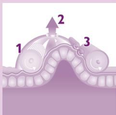
de quatre rouleaux et d'une zone centrale d'aspiration. Comme ces éléments sont contrôlés électroniquement, le système d'action 3-en-1 permet un massage fluide et continu.
