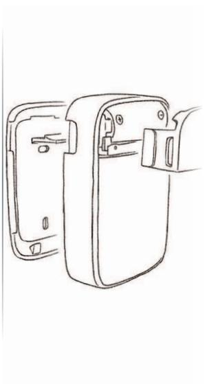
**2.** Inserisci la batteria e applica i coperchietti più piccoli sulla parte frontale e quelli più grandi sul retro di motion tramite semplice innesto.
