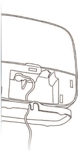
**1.** Collega l'alimentatore a **base** e alla presa vicina al tuo router per Internet (utilizza per questo l'apertura nel supporto di **base**). Quando l'illuminazione LED superiore su **base** si accende, il collegamento è riuscito.
