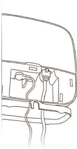
**2.** Collega il cavo LAN al tuo router per Internet e a **base** (tramite l'apertura nel supporto). Se il collegamento è riuscito, l'illuminazione LED centrale si accende.
