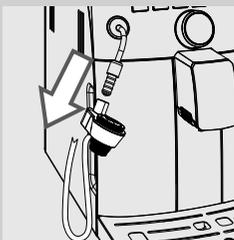
**2** Rimuovere il Montalatte automatico dal tubo vapore/acqua calda.
