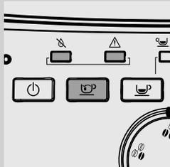
**14** I led "⚡" "⚠" e il led del tasto "☕" iniziano a lampeggiare velocemente per indicare che è necessario procedere al caricamento del circuito idraulico.
