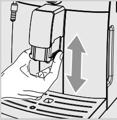
Per effettuare la regolazione, alzare o abbassare manualmente l'erogatore con le dita come mostrato in figura.
