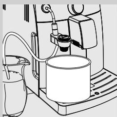
**11** Vuotare il contenitore e riposizionarlo sotto il Montalatte automatico.
