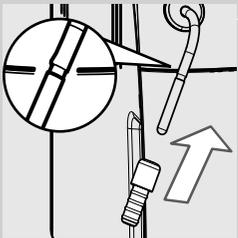
**26** Reinserire la protezione in gomma sul tubo vapore.
