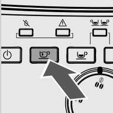
**3** Premere il tasto "☺" per avviare l'erogazione di acqua calda.
