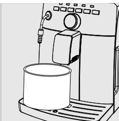
**17** Vuotare il contenitore e riposizionarlo sotto il tubo vapore/acqua calda e l'erogatore.
