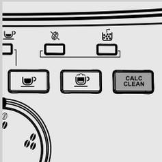
**7** Tenere premuto il tasto "CALC CLEAN" per 3 secondi. Quando il tasto inizia a lampeggiare, rilasciarlo per avviare il ciclo. Il tasto "CALC CLEAN" lampeggia durante l'esecuzione dell'intero ciclo di decalcificazione.
