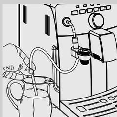
**3** Inserire il tubo di aspirazione nel contenitore.
