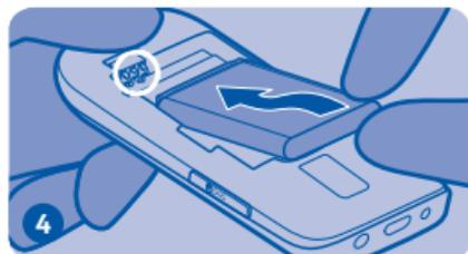
Alignez les contacts de la batterie, puis insérez la batterie.
