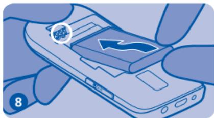
8 Alignez les contacts de la batterie, puis insérez la batterie.
