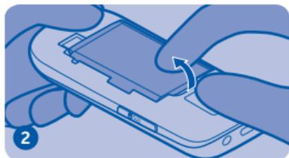
2 Si la batterie est insérée dans le téléphone, soulevez-la pour la retirer.
