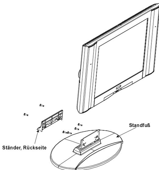
2- Setzen Sie die 4 Aufhänger in die runden Schraubenlöcher an der Rückseite des TFT ein und fixieren Sie sie mit 4 (M4 x 10) Schrauben am TFT-Gerät.
