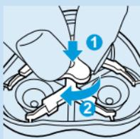
**5** Setzen Sie die Schereinheit wieder zusammen, und setzen Sie den Scherkopfhalter wieder auf. Drücken Sie das Rädchen an (1), und drehen Sie es im Uhrzeigersinn fest (2).
