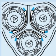
**4** Nehmen Sie die Scherköpfe heraus, und setzen Sie die neuen Scherköpfe so in die Rasiereinheit ein, daß die Seiten mit den kleinen Öffnungen zur Mitte der Rasiereinheit zeigen.
