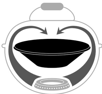
Pour la plupart des utilisations du barbecue, la position optimale de l'entonnoir est la position Standard. Elle permet une circulation idéale dans la sphère. Les aliments sont grillés de manière totalement homogène, sans devoir les retourner. Viande, poisson, légumes et autres restent bien juteux, tendres et croquants.
