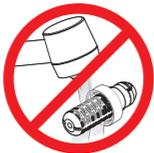
Ne rincez pas l'EZ-Clean Membrane™ en la tenant en position horizontale: les fibres creuses risquent d'être détruites par l'action de l'eau.
